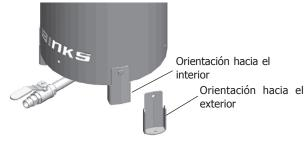
Las patas se pueden orientar hacia adentro o hacia afuera para proporcionar flexibilidad en el montaje.
